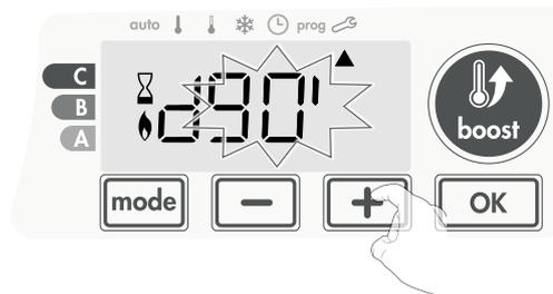
13- Pour valider et passer automatiquement au réglage suivant, appuyez sur .
